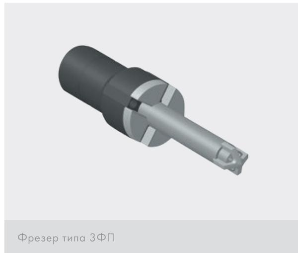
Фрезеры пилотные типов 2ФП и 3ФП предназначены для сплошного разрушения прихватченного объекта с опережающим фрезерованием его внутреннего диаметра.
