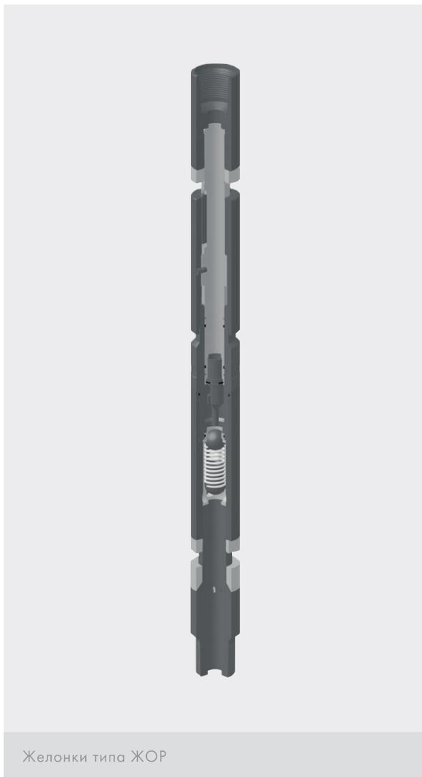
**Желонки типа ЖОР** предназначены для работы в комплексах очистки скважин типа КОС для удаления песка, шлама, окалины, кусков породы, металла и кабеля и обеспечивают очистку скважины без организации в ней циркуляционной промывки. Принцип действия желонок основан на использовании перепада давления жидкости между скважиной и полостью над верхним клапаном желонки. Желонки применяют в следующих случаях:
