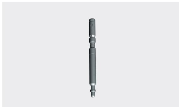
Инструмент подъёма ИПК 25-К2 предназначен для подъема клапана ингибиторного и клапана глухого из скважинной камеры с использованием стандартной канатной техники и механического ясса типа ЯМ.
