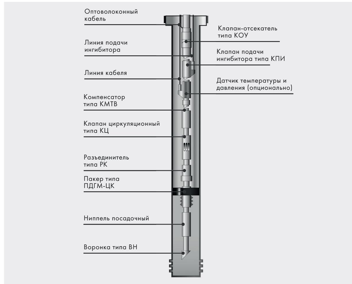
2. Комплекс подземного оборудования для добычи газа с датчиком контроля давления и температуры и ингибиторным клапаном.
