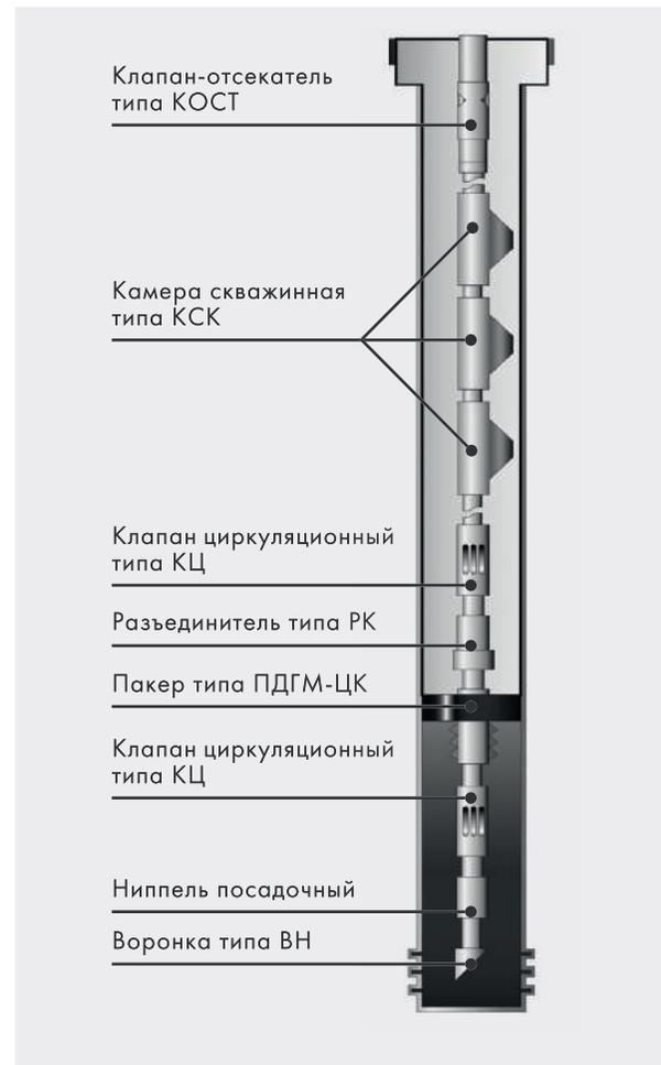
4. Комплекс подземного оборудования для добычи нефти газлифтным способом.
