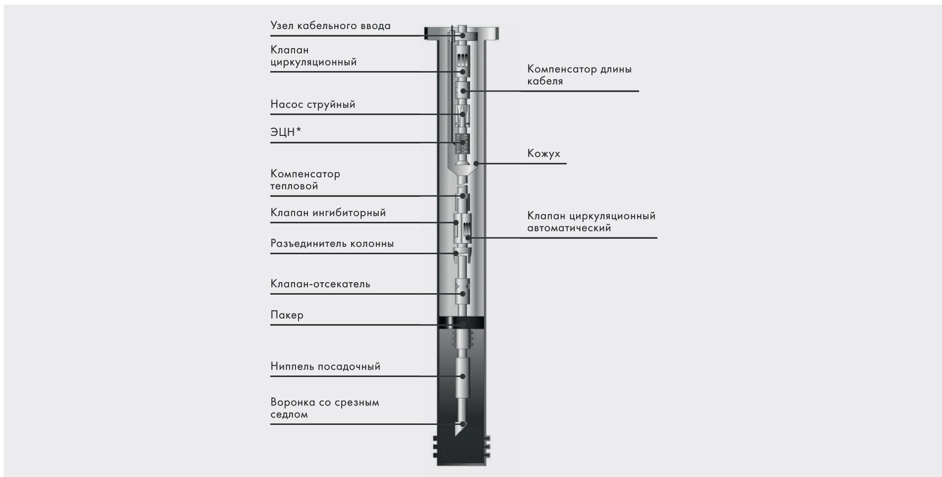
6. Комплекс подземного оборудования добычи нефти механизированным способом с защитным кожухом под ЭЦН.
