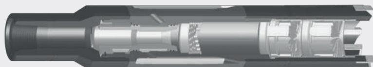
Устройство очистки забоя скважины типа УОЗС
