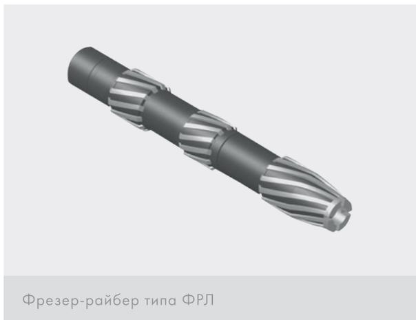
**Фрезеры-райберы типа ФРЛ, ФР, РПМ и ФРС** предназначены для вырезания «окна» в обсадной колонне при забуривании боковых стволов, а также для фрезерования стенок обсадных колонн, удаления смятий, задигов, проработки интервалов перфорации с использованием УБТ. Рабочая поверхность включает в себя цилиндрический, конический райберы и кольцевой фрезер. В верхней части фрезера-райбера нарезана замковая резьба для подсоединения труб к бурильной колонне. Промывочное отверстие – центральное.
