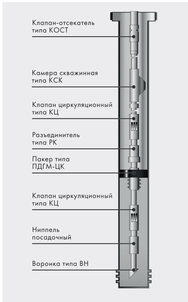
3. Комплекс подземного оборудования для добычи газа со скоростным клапаном-отсекателем.
