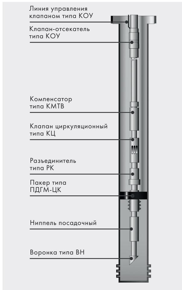
1. Комплекс подземного оборудования для добычи газа с гидрорегулируемым клапаном-отсекателем.
