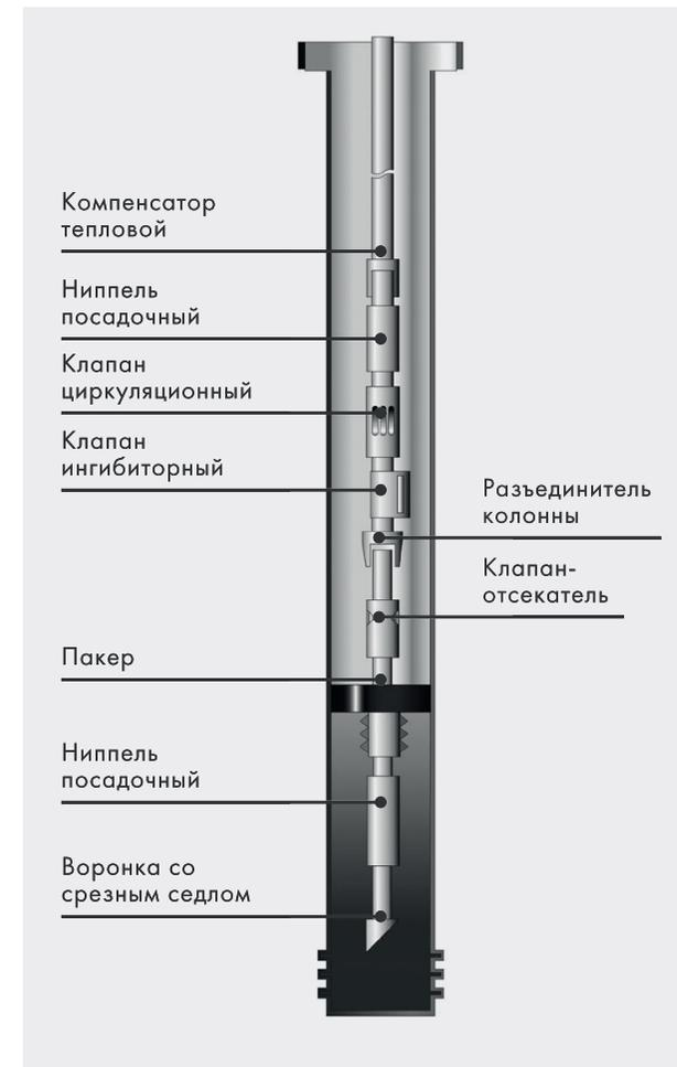
5. Комплекс подземного оборудования для добычи нефти фонтанным способом.
