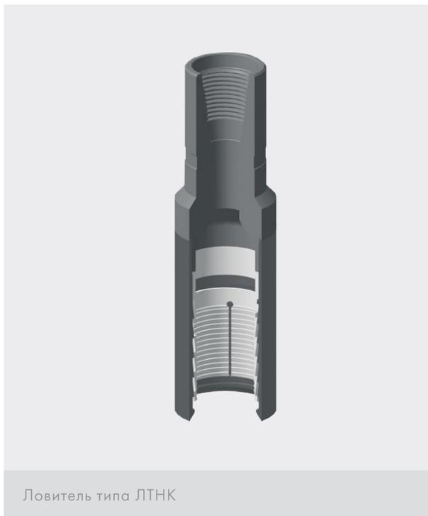
Ловители наружного короткого захвата типа ЛТНК предназначены для захвата и удержания за наружную поверхность элементов аварийных объектов, которые из-за небольшой длины не могут быть захвачены ловителями типа ЛТН.
