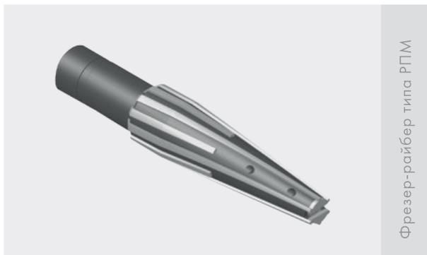
Фрезер-райбер типа РПМ прорезает «окно» в колоннах также за один спускоподъем. Отличается наличием цилиндрической режущей части. Фрезеры-райберы выпускаются для работы в колоннах диаметром 146, 168, 219 и 245 мм.
