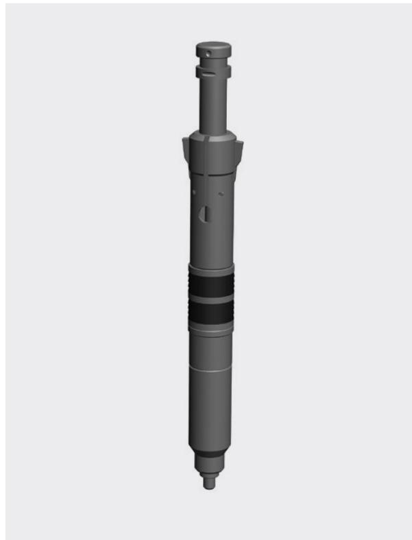
**Глухая пробка типа ПГ** предназначена для изоляции двух частей трубного пространства – над ней и под ней, и воспринимает рабочее давление с любой стороны, но большее рабочее давление возможно от устья к забою и 80% от него в обратном направлении. Отличие при работе с глухой пробкой по сравнению с обратным клапаном заключается в том, что извлечение пробки проводится за две спуско-подъемные операции.
