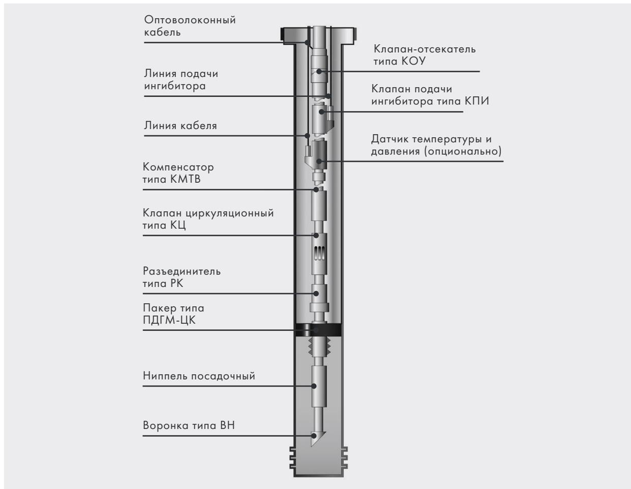
2. Комплекс подземного оборудования для добычи газа с датчиком контроля давления и температуры и ингибиторным клапаном.
