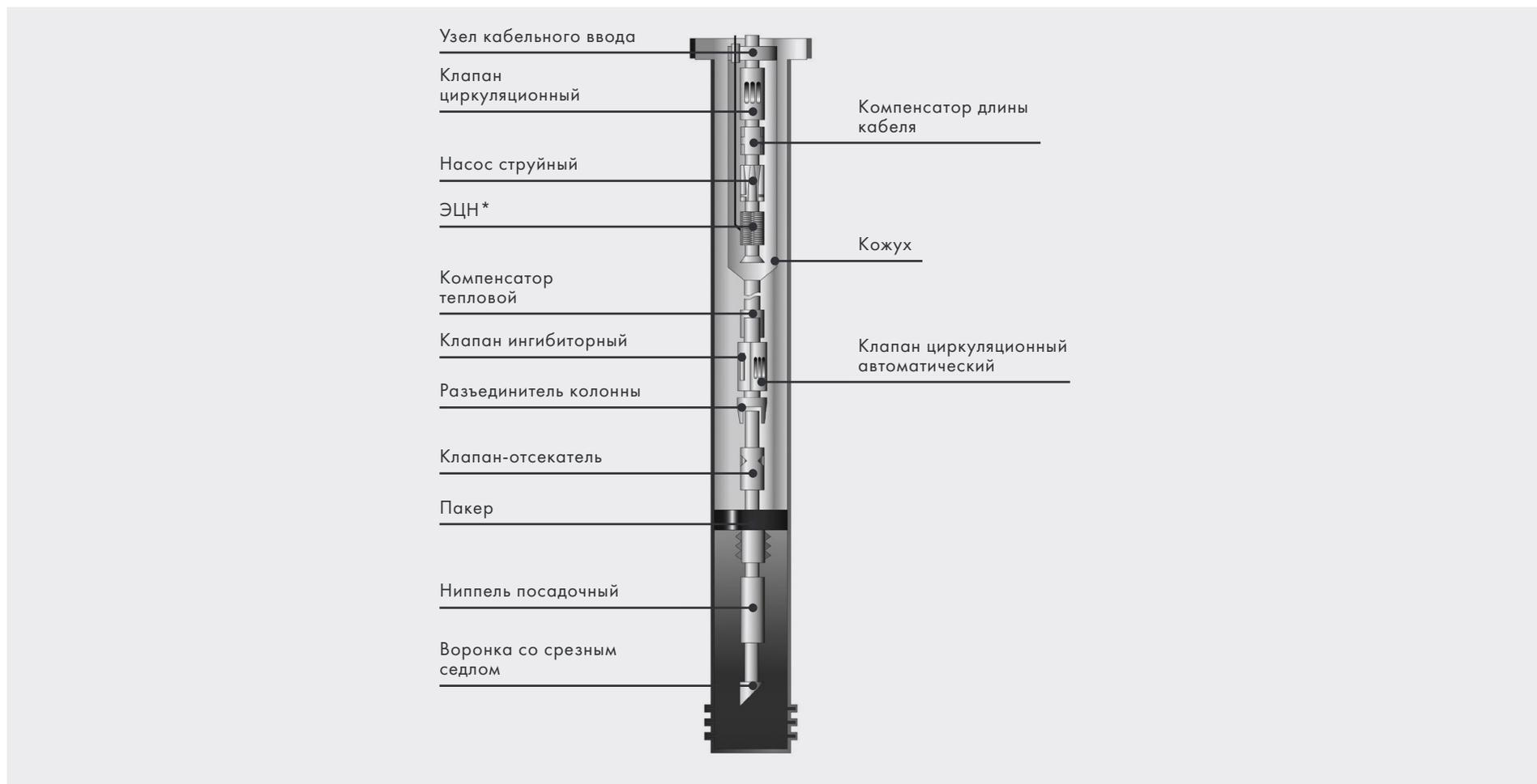
6. Комплекс подземного оборудования добычи нефти механизированным способом с защитным кожухом под ЭЦН.
