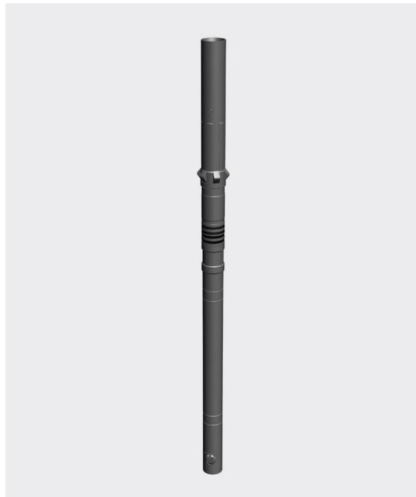
**Клапан-отсекатель коростной типа КОСТ** предназначен для предотвращения нерегулируемого истечения потока газа и нефти в случае разгерметизации (фонтанирования) устья скважины. Принцип срабатывания клапана основан на изменении перепада давления при увеличении скорости потока через фиксированное отверстие.
