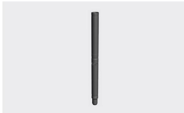
Циркуляционный клапан типа ЦК, совмещенный с посадочным ниппелем типа F, предназначен для разобщения и соединения трубного и затрубного пространства для замещения в них жидкостей глушения и газа другими технологическими жидкостями.
