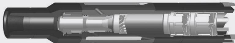
Устройство очистки забоя скважины типа УОЗС
