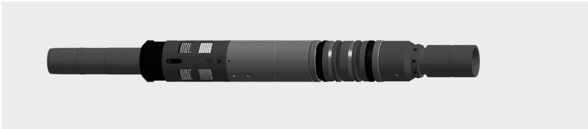
Пакеры типа ПДГМ-ЦК предназначены для герметичного разобщения интервалов ствола обсадной колонны и защиты ее от воздействия среды при эксплуатации скважин и проведении операций по воздействию на пласт.
