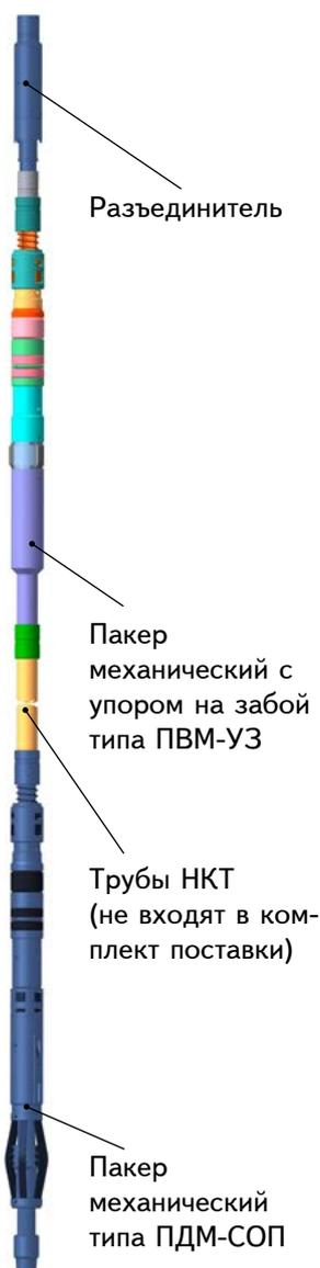
**Системы пакеров типа СПИОТ** предназначены для длительной изоляции негерметичного участка эксплуатационной колонны, разобщения пластов и защиты интервала эксплуатационной колонны труб от воздействия среды в процессе эксплуатации нефтяных, газовых и нагнетательных скважин.
