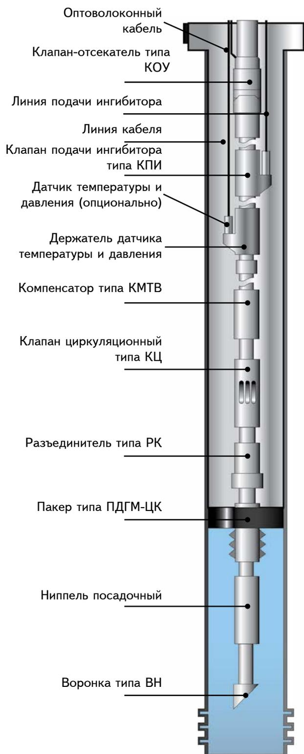
5. Комплекс подземного оборудования для добычи нефти фонтанным способом.
