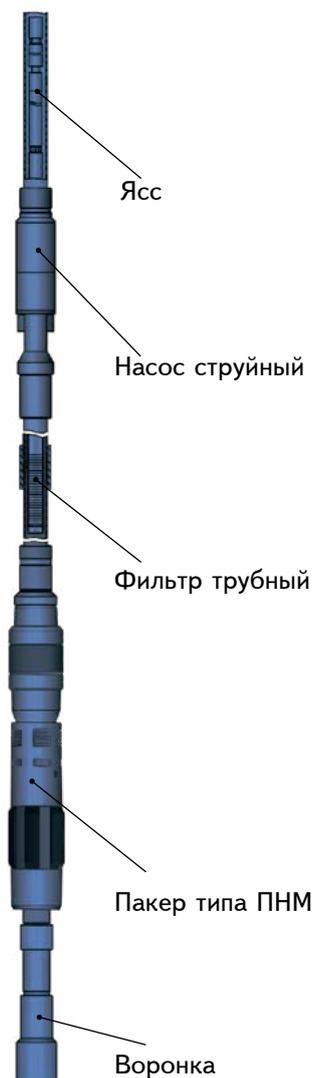
**Комплексы типа КМВП** предназначены для организации работ по депрессионному воздействию на продуктивный пласт и интенсификации добычи нефти. Работа комплексов основана на создании струйным насосом под пакером пониженного давления заданной величины во время проведения работ по освоению и исследованию скважины или интенсификации притока углеводородов из пласта.
